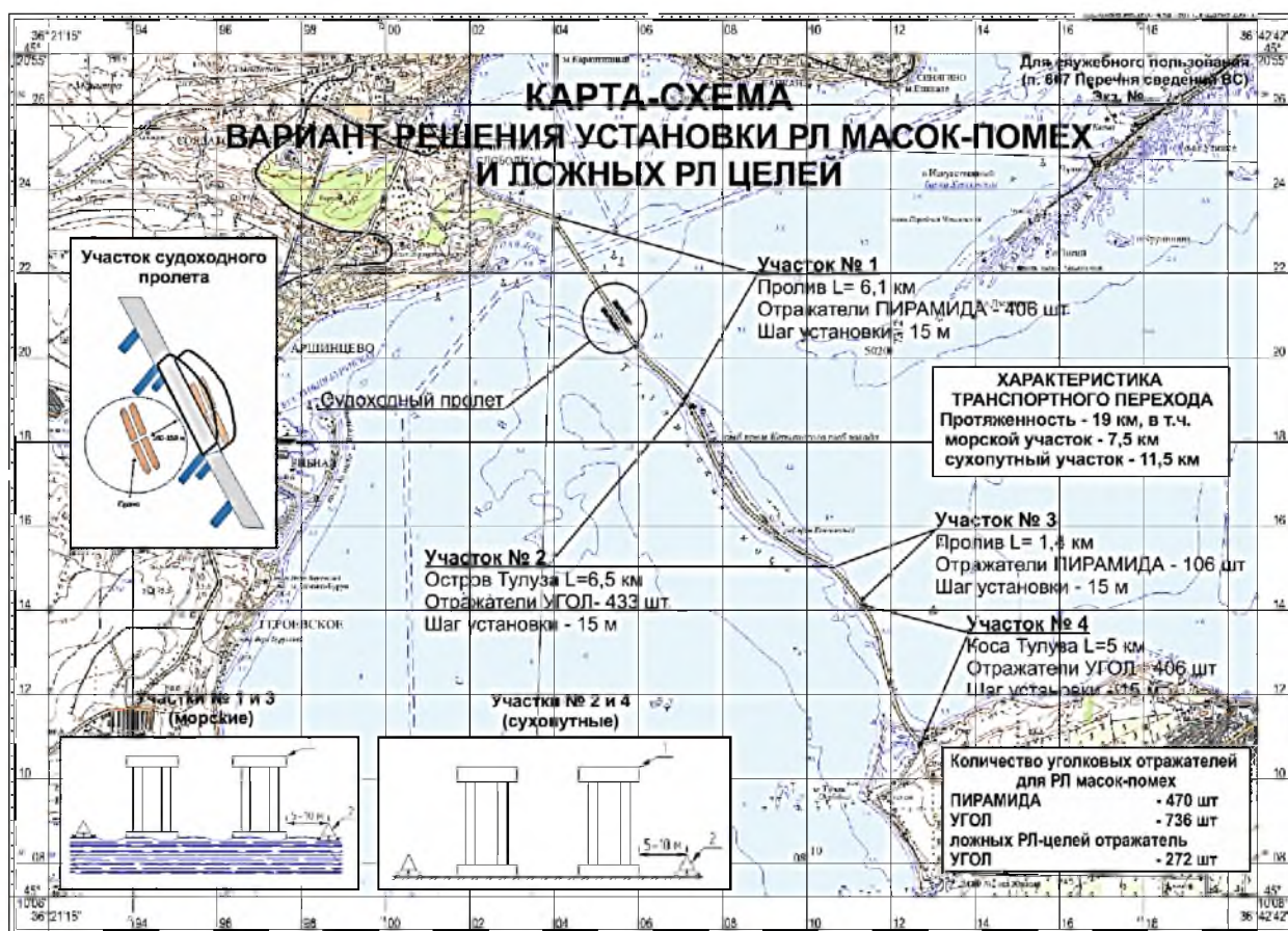
Рисунок III.44 – Карта-схема. Вариант решения установки РЛ масок-помех и ложных РЛ целей
