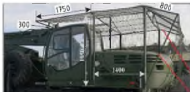
Защита оборудования (вид слева)
