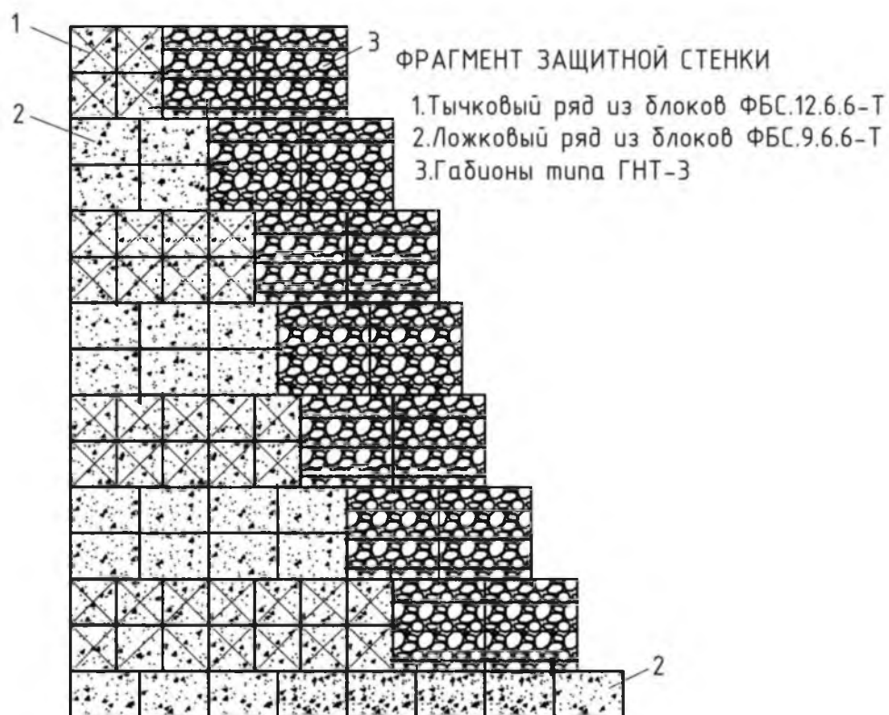
Рисунок IV.7 - Фрагмент защитной стенки
