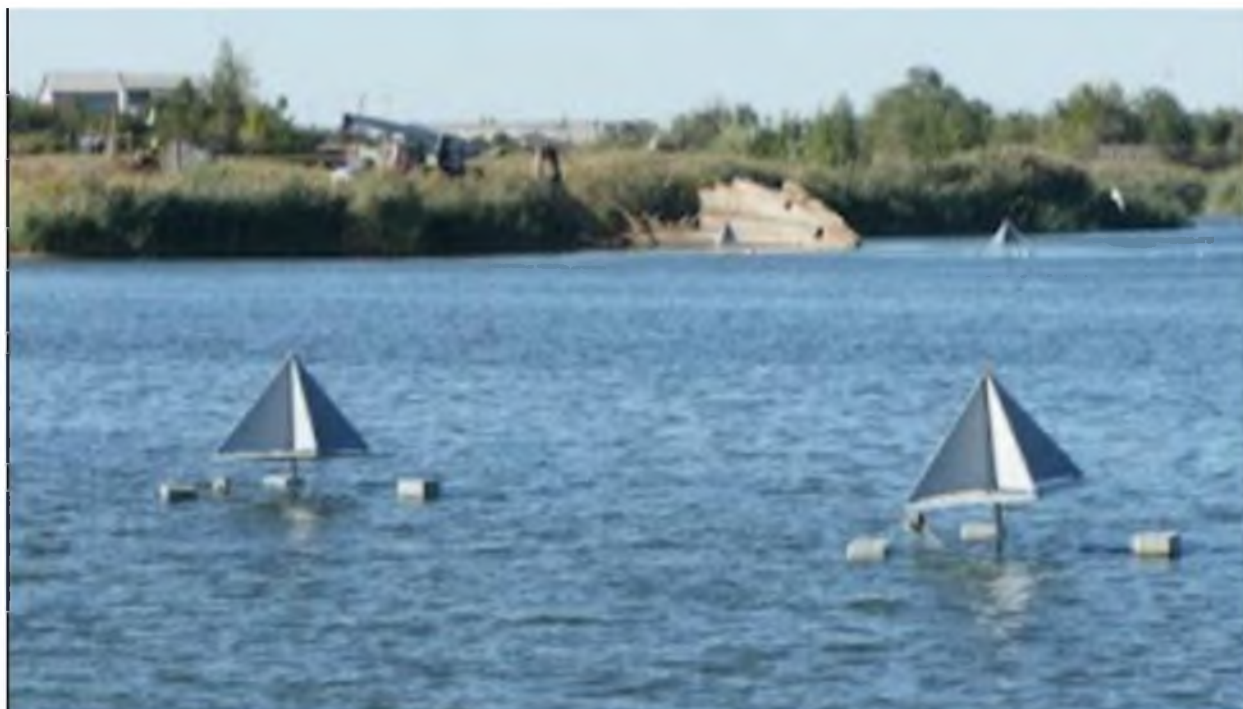
Рисунок III.49 – Пример размещения отражателей «Пирамида» на водной поверхности
