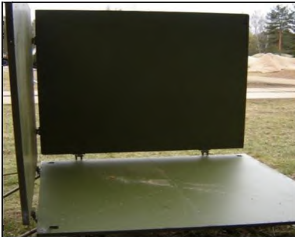
Рисунок III.45 – Пример размещения радиолокационных угловых отражателей «Угол»
