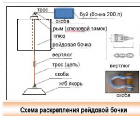
Рис. № 4 Рейдовая бочка и схема ее раскрепления
