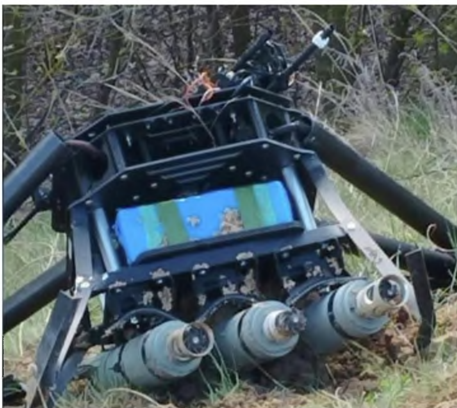
Рисунок I.12 - Боевая нагрузка БПЛА «Баба-Яга»
