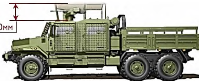
Рисунок III.15 – Рекомендации по установки защитных сеток и козырьков
