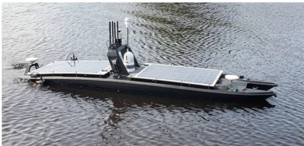
Рисунок I.18 - Морской разведывательный безэкипажный катер UUV MANTAS T-12, оснащённый солнечными батареями
