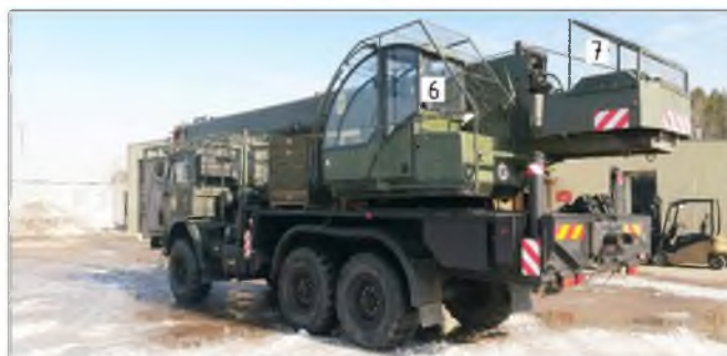
Рисунок А.4 – Узлы крепления защитных панелей КС45719
