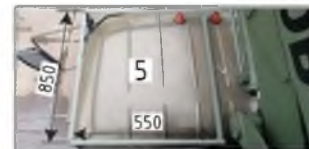
Верхняя защитная панель кабины водителя (вид сверху)
